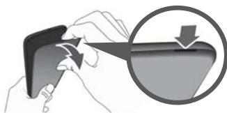
2-1. 本機の下面の溝を利用して背面カバーを取り外します。
