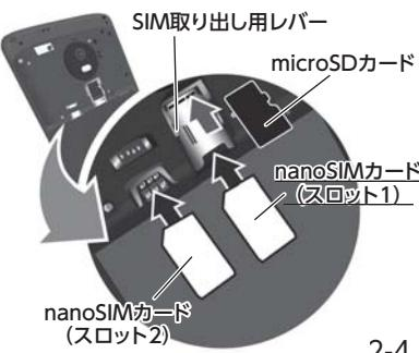
2-3. nanoSIMカードを金色の端子が下を向いた状態でSIMカードスロット1に挿入します。
