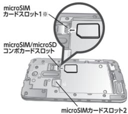
2-3. SIMカードをmicroSIMカードスロット1に挿入します。
