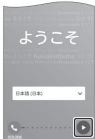
3-1. 本機の電源をONにして、表示された画面の▶をタップします。
