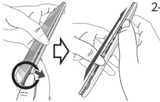
2-1. 本機の右下にある溝の位置を確認します。溝を利用して、バックパネルカバーを取り外します。
